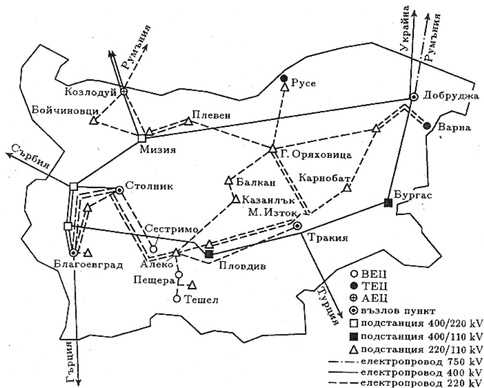
Фиг. 2 Схема на електропреносната система за 220 и 400 kV на РБългария
