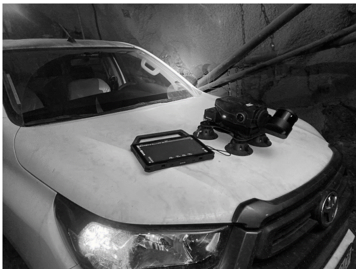
Фиг.13 Монтиране на Eup Nexys Pro на предният капак на автомобил
