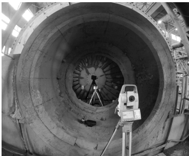
Фиг.5 Подготовка за сканиране на полуавтогенна мелница
